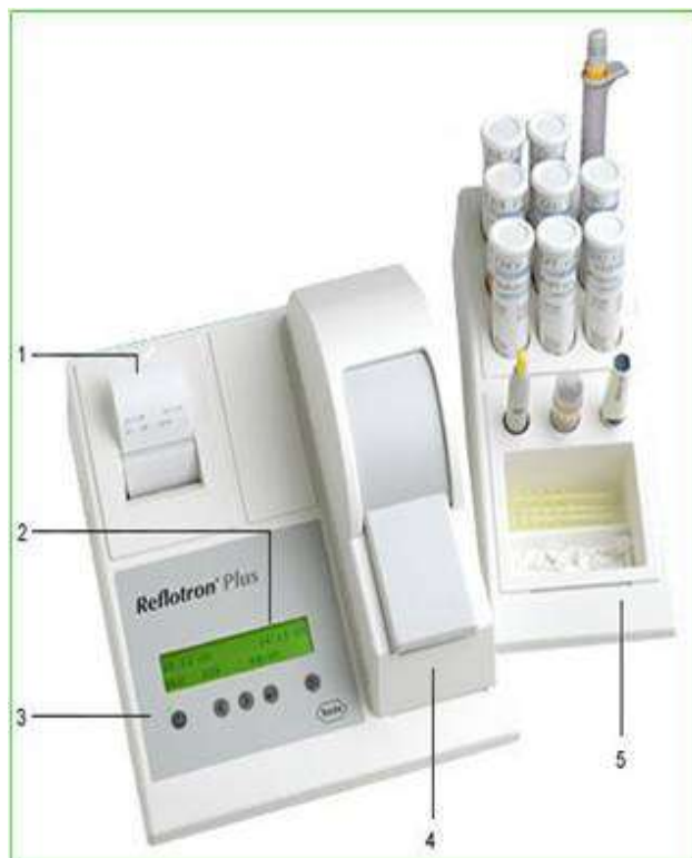
Obr. 3. Reflotron® Plus (Roche). 1 – tiskárna, 2 – displej, 3 – indikační LED diody, 4 – podavač a komora pro měření reagenčního proužku, 5 – stojánek na reagenty
