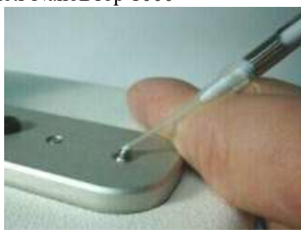
Obr. 5. Nanášení vzorku DNA na spektrofotometr NanoDrop 1000
