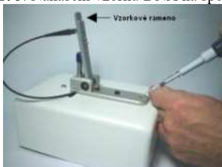
Obr. 5. Nanášení vzorku DNA na spektrofotometr NanoDrop 1000
